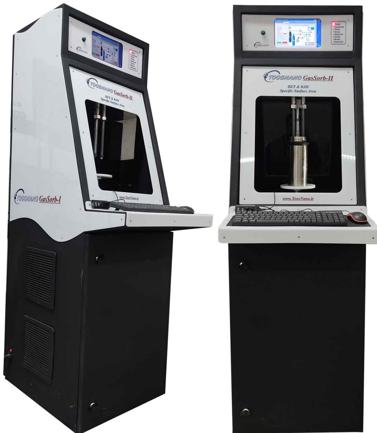
نمایی از دستگاه اندازه‌گیری سطح ویژه و محاسبه توزیع اندازه حفرات
