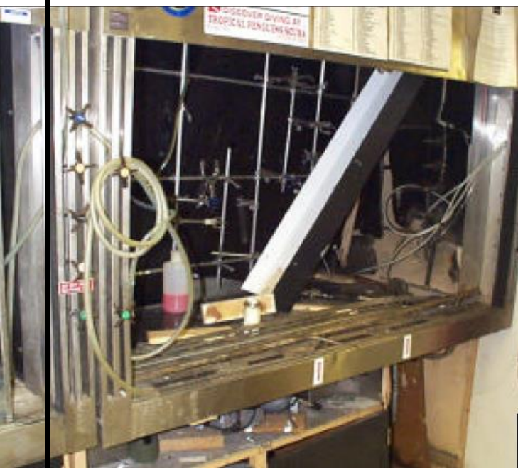
تصویر ۲. انفجار سیلندر حاوی متیل نیتريت سنتز شده توسط دانشجو، درون هود آزمایشگاهی در دانشگاه نوادای آمریکا
