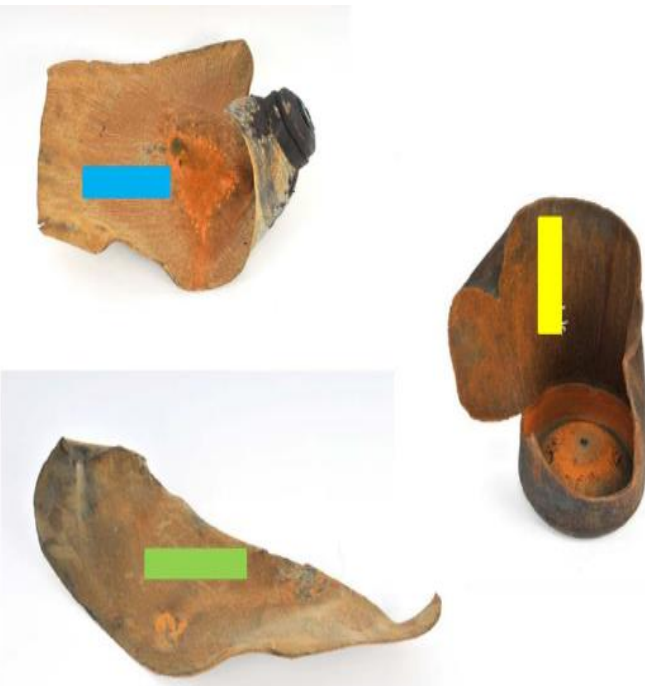
تصویر ۳. انفجار سیلندر گاز استیلن در یک کارخانه در بریتانیا
