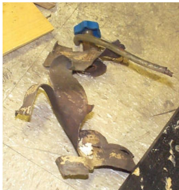
تصویر ۲. انفجار سیلندر حاوی متیل نیتريت سنتز شده توسط دانشجو، درون هود آزمایشگاهی در دانشگاه نوادای آمریکا
