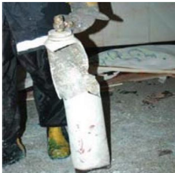
تصویر ۱. انفجار کپسول گاز هیدروژن در آزمایشگاه شیمی تجزیه دانشکده علوم پایه دانشگاه تربیت مدرس
